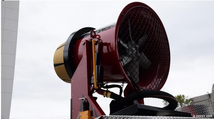
Cela garantit un transfert de chaleur optimal et favorise l'évaporation avant que l'eau n'ait la chance de frapper et de s'accumuler sur le sol. Le temps est critique dans la lutte contre les incendies : l'eau qui ne s'évapore pas n'est pas utilisée efficacement. Le canon Drago utilise 70 % d'eau en moins et fait que chaque goutte compte.
