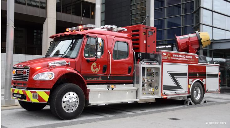
Le canon Drago utilise une technologie de pulvérisation constante distinctive et brevetée et une conception unique pour sa buse centrale (Spider) afin d'offrir une courbe de performance lisse avec des paramètres optimaux de débit d'eau et de qualité des gouttelettes.
